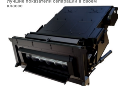
Рис. 2 Наклонная камера с высокой пропускной способностью
